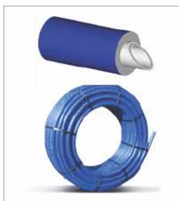
Tubo Multistrato PREISOLATO con guaina in PE espanso a cellule chiuse per acqua fredda.
